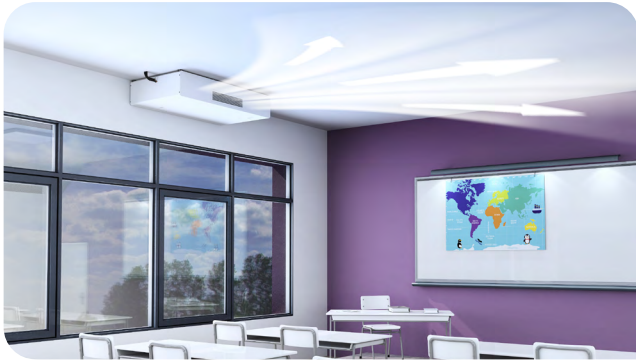
Montage plafonnier : entrée et sortie d'air murales (grille à défecteurs recommandée).
