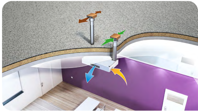
Entrée d'air et rejet en toiture.
