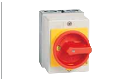
Interrupteur de proximité tri-cadenassable, IP 65, non monté, pour moteur 1 vitesse ou 2 vitesses 20 A.
