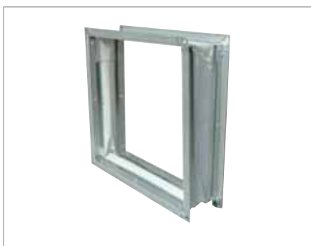
Manchettes souples GMS pour raccordement rectangulaire grande section pour aspiration. Double cadre : un cadre pour se raccorder à l'aspiration du caisson et un cadre pour se raccorder au réseau.
